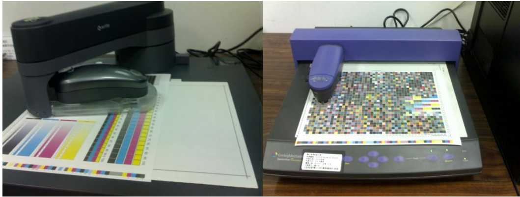
圖 4. 反射式分光光譜儀讀取系統
