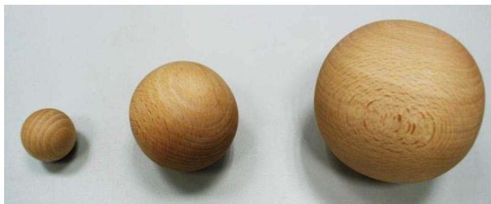
圖 5. 實驗二中所使用之樣品，直徑從左至右依序為 3 公分、6 公分、9 公分。
